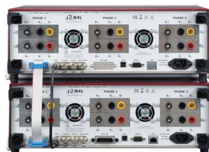
Анализаторы ПРИЗМА-550 в режиме «Ведущий-Ведомый», синхронизированные для анализа 4~6 фазных систем
